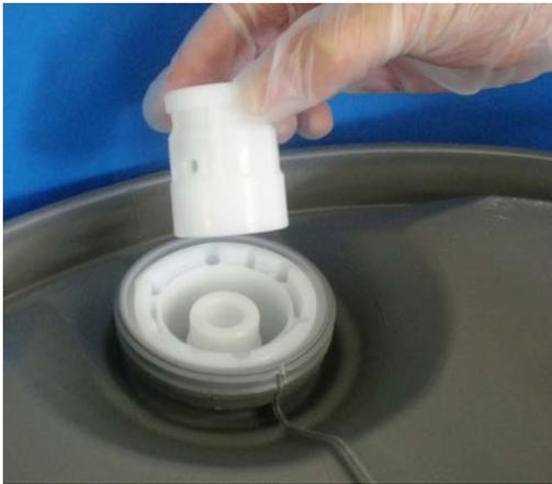
治具を使用し、時計回りに3回回転した後、トルクレンチで締め込んでください。
